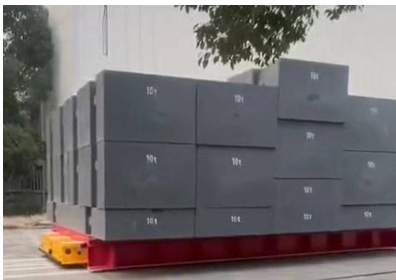
超重量物の自動搬送を担う超大型 AGV の例
