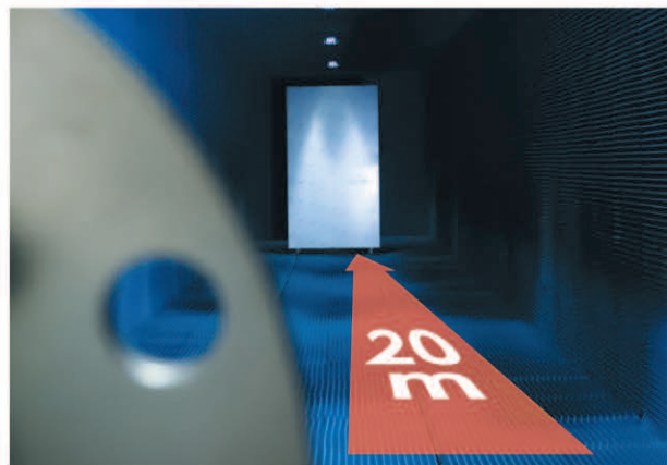
写真「Waveラボ」内の電波暗室
