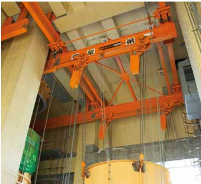
トンネル等の換気所内で、換気設備の設置やメンテナンスに使用する井桁をしたクレーンです。井桁のダブルガードは4点つりのままテルハ（モノレール）に乗り移る装置があり、特に狭いスペースの機械の設置や撤去、メンテナンスに最適です。
