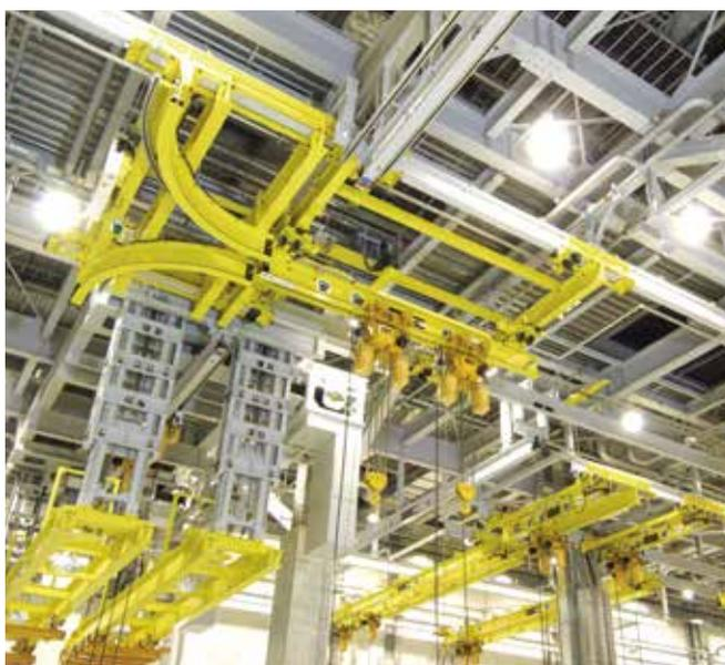
クレーンからクレーンへ、クレーンからテルハ（モノレール）へ、荷物をつったまま乗り移る装置です。次のラインへの荷の移動に最適で、工場のトータルシステムを構築するのに役立ちます。手動式と電動式の2種類があります。
