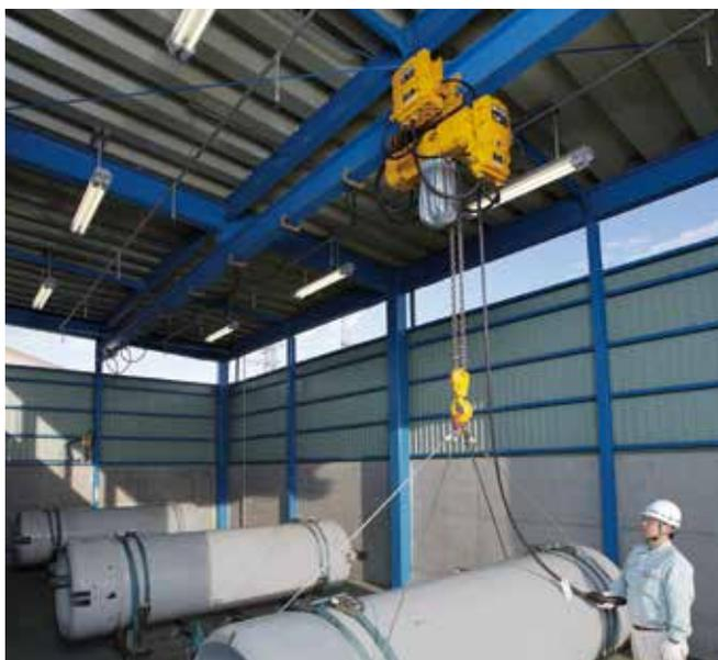
国際規格に適合した防爆形で、押ボタンスイッチ部分に本質安全防爆構造を採用したクレーンです。石油化学工場・石油精製工場・塗装工場など可燃性ガスや蒸気（爆発性ガス）の存在する場所における荷役作業の危険を防止します。また、独自のブレーキ付モータにより、滑らかな起動・停止を実現。オーバーヘッド形とローヘッド形のどちらかをお選びいただけます。
