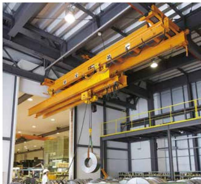
ガーダ部分が伸縮機能を持つクレーンです。テルハ（モノレール）タイプと走行クレーンタイプの2種類があり、テルハタイプは二層のIビームのうち下段のIビームがスライドし、外の荷を建屋内に取りこむことができます。走行クレーンタイプは柱などによるデッドゾーンへスライドするので、作業範囲が広がります。
