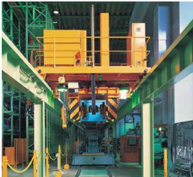
コンピュータとオンラインで結ばれた自動搬送クレーンと自動着脱のハンドリング機構をもった、全自動クレーンです。コンピュータによってプログラムされた指示により、各工程ごとの全時間を正確にコントロールしながらスムーズな作業を実現します。
