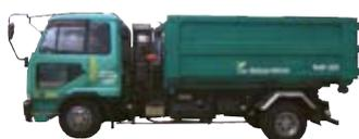
キンカングループのスタンダード車輛です。コンテナ(荷台)がそのまま降ろせ、廃棄物排出の都度、コンテナに投入していただけます。コンテナ交換が可能です。
