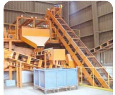
2 木くずを粉碎してチップを製造します。
