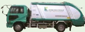
圧縮型の積み込み車両です。重量が軽く圧縮できる廃棄物を大量に積み込むことができます。
