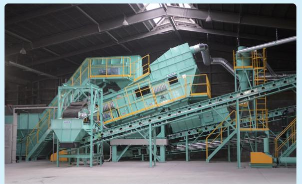
混合廃棄物を比重差によって、重量物・軽量物・細粒物に分別します。その後、レーン上で磁選機や人の手を用いてより精度の高い選別を行います。
