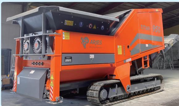
大型の破碎機の導入により、これまで破碎困難、処理困難物であった、大判シート状や大きなロール状の廃棄物も破碎処理が可能となりました。破碎スピードも向上し、処理能力は以前の2.8倍を誇ります。
