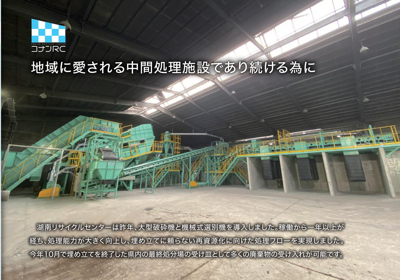
湖南リサイクルセンターは昨年、大型破碎機と機械式選別機を導入しました。稼働から一年以上が経ち、処理能力が大きく向上し、埋め立てに頼らない再資源化に向けた処理フローを実現しました。今年10月で埋め立てを終了した県内の最終処分場の受け皿として多くの廃棄物の受け入れが可能です。
