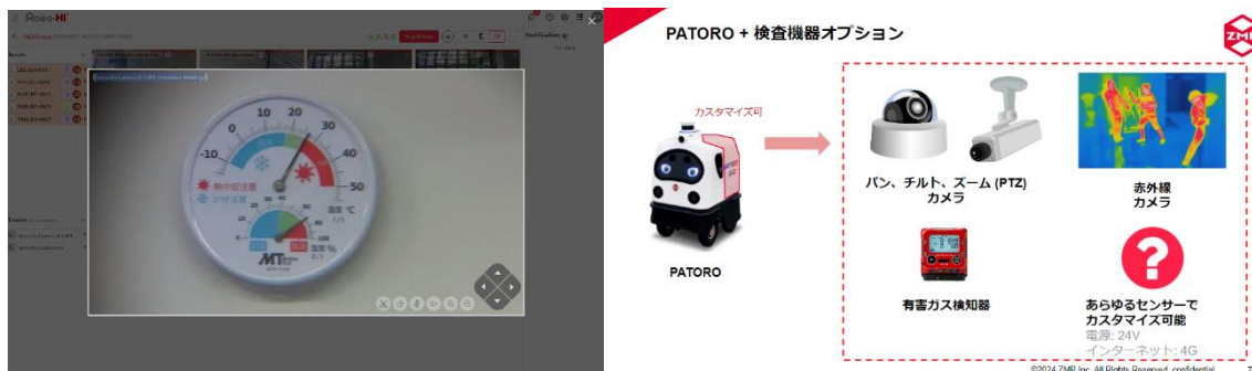
<パン、チルト、ズーム (PTZ) を実行して検査ポイントの鮮明な画像を取得出来ます(左)> <『パトロ』にオプション搭載可能な各種検査機器イメージ(右)>
