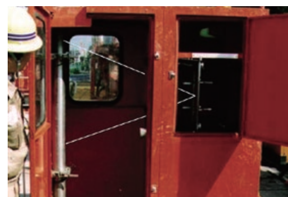
ノズルチェッカー：現場においていつでも噴流の交差状態を確認できます。
