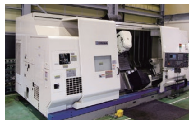
高性能な噴流を作り出すためのモニター製作用マザーマシン (テクノセンター)
