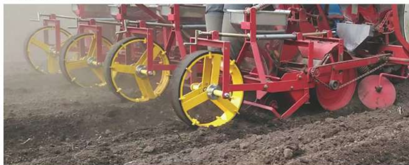
鉄輪に0.27mmの鉄板をボルトナット4カ所で止め、鉄板の上から厚み1cmのスポンジを貼る交換式
