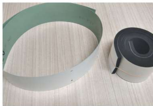
鉄輪に0.27mmの鉄板をボルトナット4カ所で止め、鉄板の上から厚み1cmのスポンジを貼る交換式
