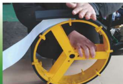
鉄板を本体に巻きつけ外側からボルトを通し、内側でナット止め 鉄板の外周にテープ付きスポンジを貼って交換完了
