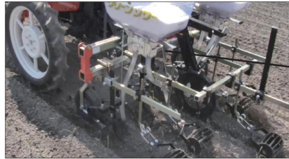
施肥機は接地輪タイプの車速連動タイプ。肥料は玉ねぎの真上に投下していきます。
