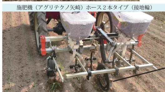
接地輪駆動なので肥料は車速に連動して一定量排出していきます。
