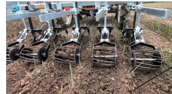
玉ねぎカルチで処理した圃場。深耕カッターで条間の排水性を向上し、ゴロださんで土塊を抑える事と、表面の土を細かくしていきます。その後、玉ねぎクラッシャーBにより土塊を細かく砕いていきます。
