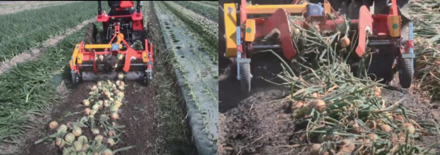
鎮圧ローラー B で、玉ねぎが落ちる前に、ローラーにより土を踏み固めることで玉ねぎの乾燥を促す効果があります。
