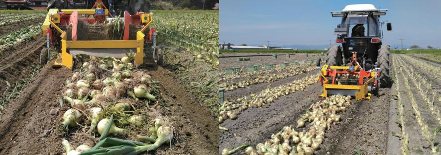
平高うねの場合、玉ねぎがデガーでの作業中に通路にこぼれてしまう場合があります。玉ねぎコレクター B を装着する事で玉ねぎがうねから落ちるのを防止します。※鎮圧ローラー B と併用可能
