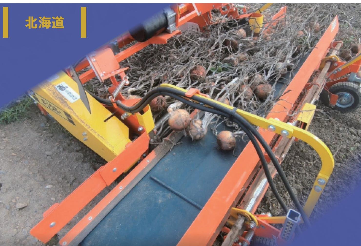
北海道の場合は主に2種類のデガーをおすすめします。第二コンベア部が「ベルトタイプ」と「ロッドタイプ」の2種類が選択出来ます。場所や条件にあわせた玉ねぎデガーが選べます。
