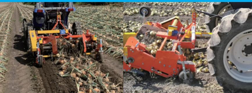
後方のみに玉ねぎを落として、デガーを使用したい場合におすすめです。集積作業を必要としない場合は、横送り機能付きコンベアなしを選択してください。
