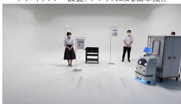
床貼付のランドマーク方式による自律移動の様子
