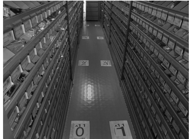
良く出る部品などは取りやすい位置、原則目の高さぐらいの位置にある
