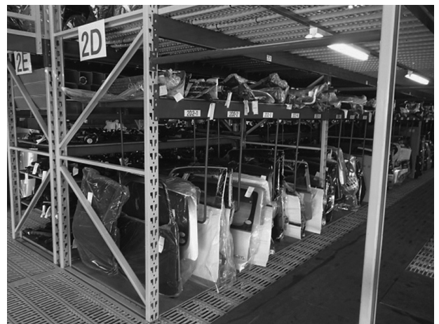
Rゲートやボンネットなどを保管する棚、専用の仕切りがあり効率的な保管が可能。仕切りも取り外し可能のため、様々なサイズに対応
