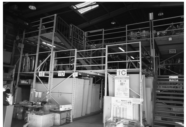
中二階の作りのメザニンラック、全体の高さも調節できるので三階層にすることも可能。商品棚のボディと呼べる
