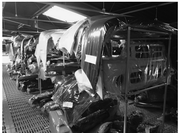
同じくニコパイプを組み合わせて作った在庫棚。「様々な形状のバンパーがあるがパイプとジョイントのニコパイプならば色々作れるので、これがあると効率が良くなる」と菅野氏
