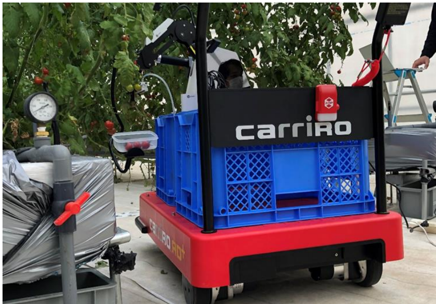
CarriRo AD+台車タイプとロボットアームが連携している様子
