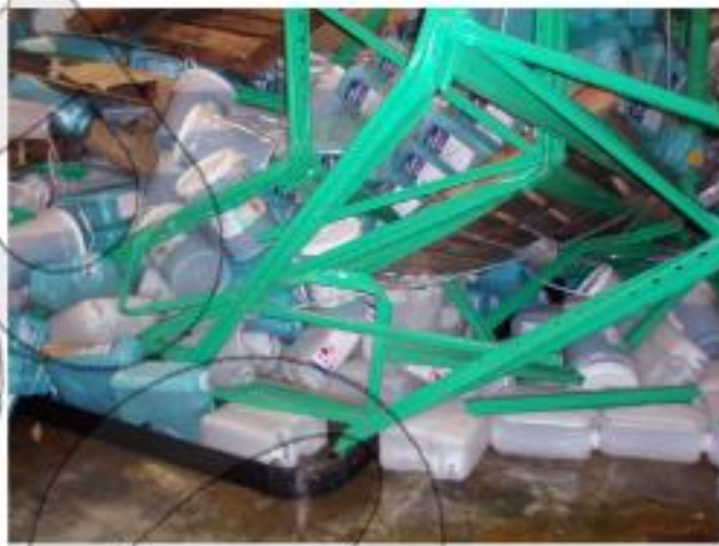
熊本地震（菊池郡） ドライブインラック水平ビーム無しによる事故
