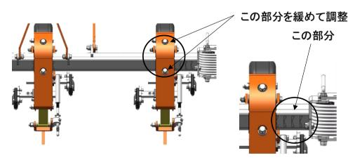
③ハンドルゲージで3本の爪の深さの調整をします。ハンドルゲージを左右に回すことでタイヤが上下し、爪の深さを調整することが可能です。爪の深さは5~8cm程度(ヤナギ刃を止めているネジ辺り)の深さで使用して下さい。
