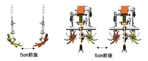
②深さの調整は、作業中に花びらが隠れる程度(ベアリングが土に潜らない)に、作業時は花びらを固定しているL型の金具が地面と水平になるように、ゲージバーと吊りかんのバネの強弱を利用して設定します。
