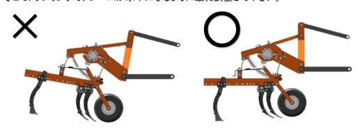
②カルチ幅の調整をします。作物の違いや圃場条件の違いで実際の条間と違う場合があります。その時はボルトを緩め実際の圃場の条間にカルチを調整して下さい。 GLカルチはフレームに刻みが入っています。60cm~75cmまで3cm刻みになっていますので、参考にして下さい。
