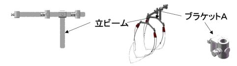
その時深さの目安として、レーキ先端側の曲がり部分が地面に3cmほど刺さるように押し込みます。 ここの刺さりが浅いと、除草作業を行った時にレーキが表面に浮き上がり、地面のうえを這うような 形になります。そのような状態になると除草作業は行われず、作物の葉や茎を痛め、欠株や生育 不良の原因となりますので注意して下さい。
