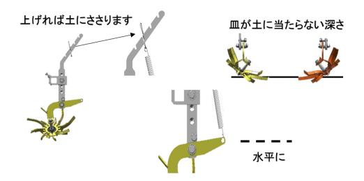
③作物の中期以降、葉が大きくなった時に砕土輪使用すると、葉っぱを巻き込む場合があります。 その時は砕土輪を作物から広げるか、使用を中止しカルチから取り外して下さい。
