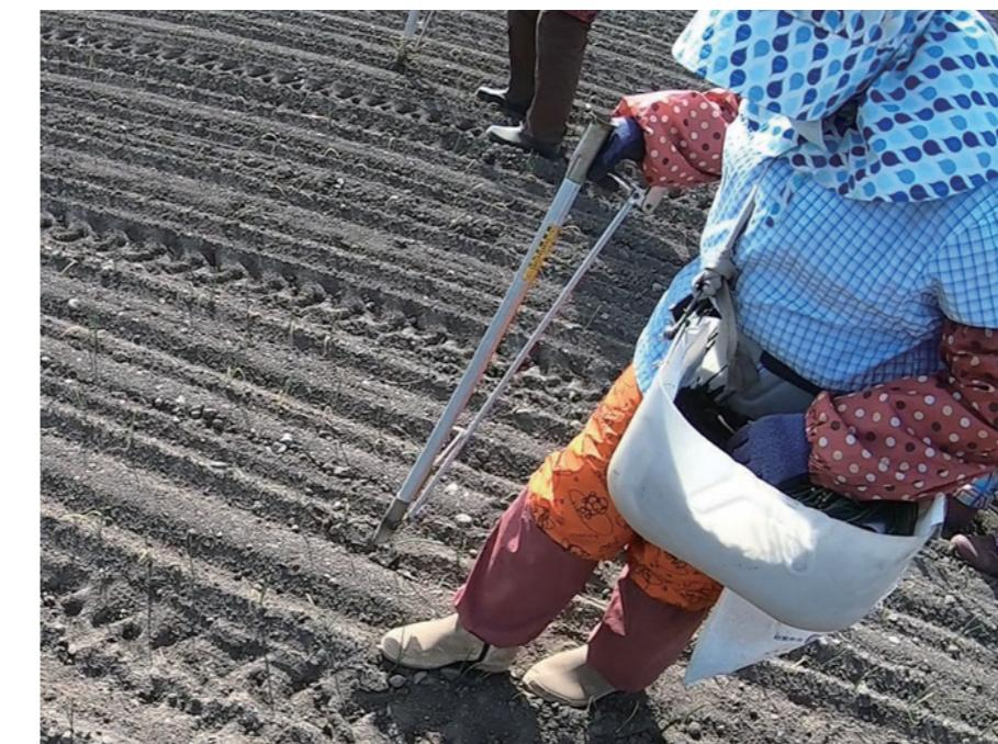
北海道では、機械移植後の欠株を補うために使用されています。欠株はそのままにせず、きちんと補植を行う事がおおいです。補植時は、苗を腰に背負いながら、欠株のあるところに補植機で植え付けをします。キュウホーの「玉ねぎ補植機」は消耗の少ない場所は、アルミ製になり、土に刺さる部分はハガネを使用しています。口先を開くためのニギリ部分は、あえて通常とは異なる逆仕様になっています。ニギリ部分を筒側にする事で、まっすぐ土に刺せる事と、そのまま手を移動せずに口先を開くニギリがありますので、長時間の作業でも疲労しにくい特徴があります。内径が 22.6mm ありますので、種の播種に使用する地域もあります。マルチの張った場所での使用も可能になります。
