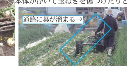
歩行型は葉の切断が長く、通路に残渣が落ちる事でトラブルが出る場合がある。
