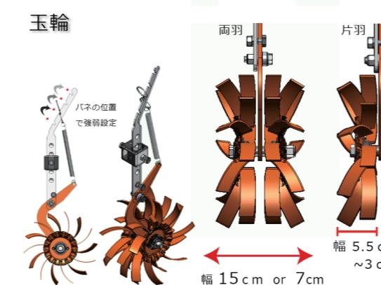
深耕カッターからでた土塊を碎く作業と、表層の土を碎いたり、攪拌したり出来ます。バネが内蔵されているので、圃場の凸凹にも追従が可能で、土に刺さるテンションの強さも設定が可能です。
