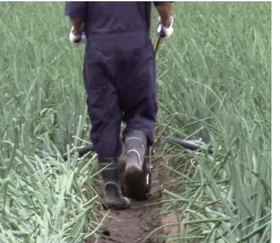
防除通路専用葉分けになります。従来、手で行っていた防除通路の葉分け作業を、手押しで行える商品です。手で分けていた時は1列しか葉分けが出来ませんが、玉助はタイヤが両サイドについているので、2列の葉分け作業が同時に可能になります。タイヤで葉を分ける事で、玉ねぎの葉が擦れない仕組みにしてあります。また、タイヤでの葉分け時に、葉がタイヤの回転に巻き込まれないよう、カバーを取り付けしていますので、葉分けでの作業時に葉が巻きこむのを防ぐ役割もあります。押す人の身長に合わせて、ハンドルの高さの調整が可能です。葉分けのクセをつける角度もタイヤの左右の広がりを調整する事で自在に設定が可能になります。注意として、玉助で出来る葉分けは、玉ねぎの葉が立った状態のみで、倒れてしまうと、葉をすぐく機能が無いため、使用が出来なくなりますでご注意ください。
