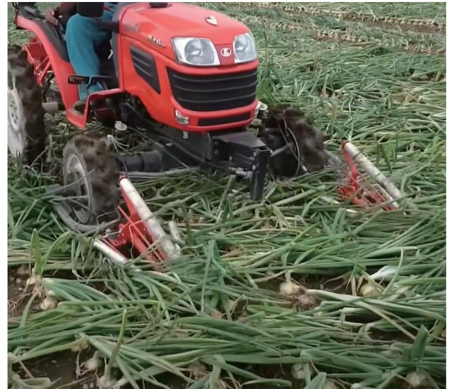
玉シャトルは北海道限定商品になります。極早生等の玉ねぎの葉が枯れていない場合に、ロングローラーがゆっくりと葉を分けていくことで、葉が絡みにくく作業ができます。ロングローラーとサイドローラーは、葉の抵抗により回転する事で、葉を傷つけにくい構造になっています。葉が枯れた場合の根切、デガー作業時は、ロングローラーが必要ないので、旋回時に、長い分、ぶつかる可能性があるので、取り外しが可能になり、従来の葉分けと同じ長さで作業が可能になります。葉を分けるためのロッドは、自在に調整が可能になっています。
