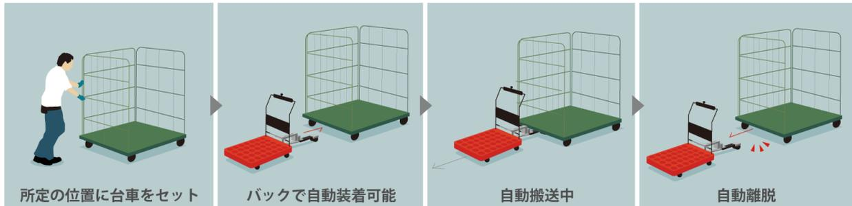
株式会社 ZMP(東京都文京区、代表取締役社長:谷口 恒、以下「ZMP」)は、物流支援ロボット CarriRo(キャリロ)の新しいオプション機能となるフルオート牽引アタッチメントの出荷を2022年3月より開始します。本機能を活用する事により、カゴ台車や六輪台車などの台車を自動で連結し、目的地まで搬送、離脱の一連の動作を完全に自動で行うことが可能になり、工場や倉庫内での搬送作業のさらなる省人化に貢献します。
