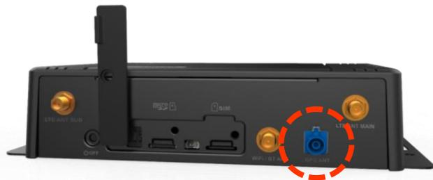
位置情報の取得に使用するGNSS衛星としては、**GPS+GLONASS+SBAS+QZSS**が設定されています。これらに**Galileo**を追加して使用することが可能です。(追加設定コマンドの実行が必要)
