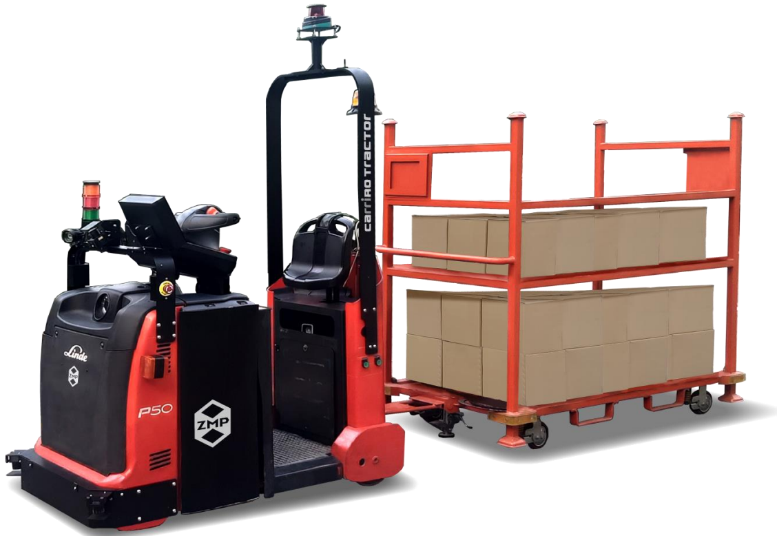
CarriRo Tractor 5T で荷物を牽引している様子
