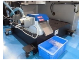
研削油供給装置150L(新作) 磁気分離機(新作) 処理能力：40L/min
