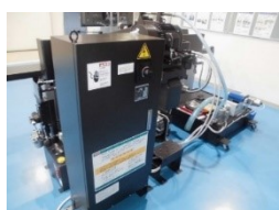
制御盤(DC24V化) (新作)
