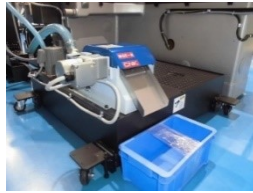
研削油供給装置150L(新作) 磁気分離機(新作) 処理能力：40L/min
