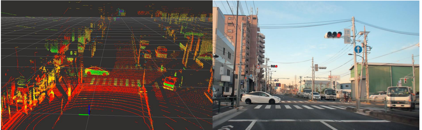
公道走行時の 128 レイヤー 3D-LiDAR(左画像)及びフロント 4K カメラ映像(右画像)イメージ
