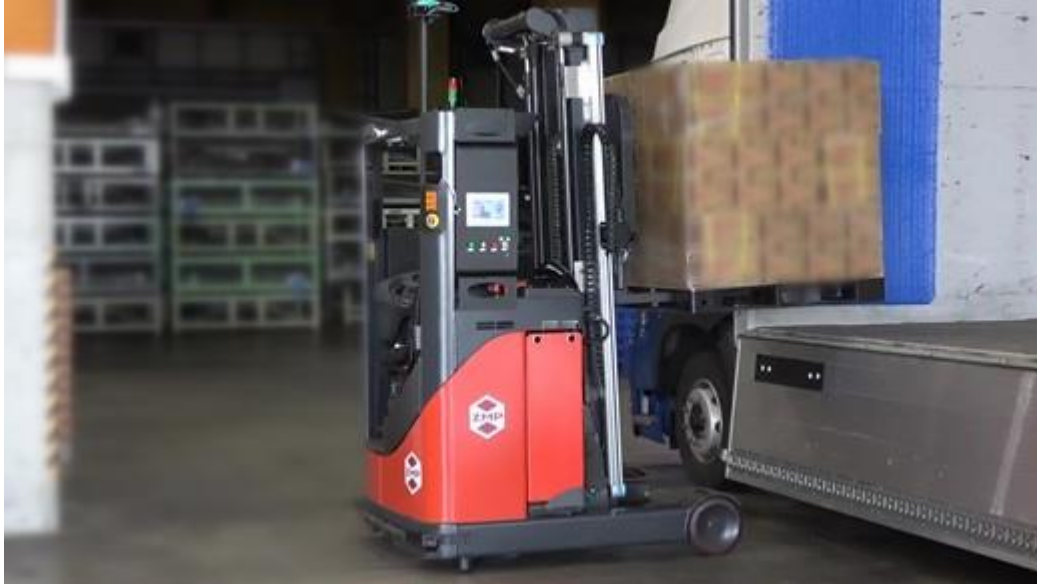
トラックからパレットを自動で積み下ろす様子
