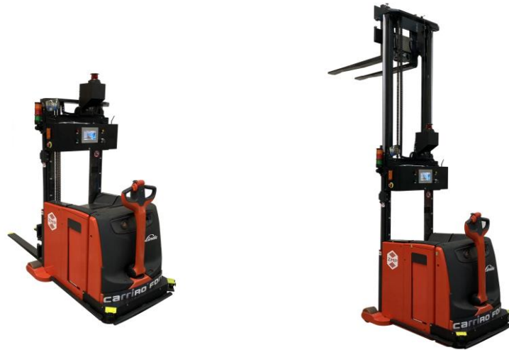
CarriRo Fork ウォーキータイプ新モデル (右画像は最大揚高 2.9メートル時)
