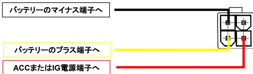
図3.3-2 車載用電源ケーブル接続
