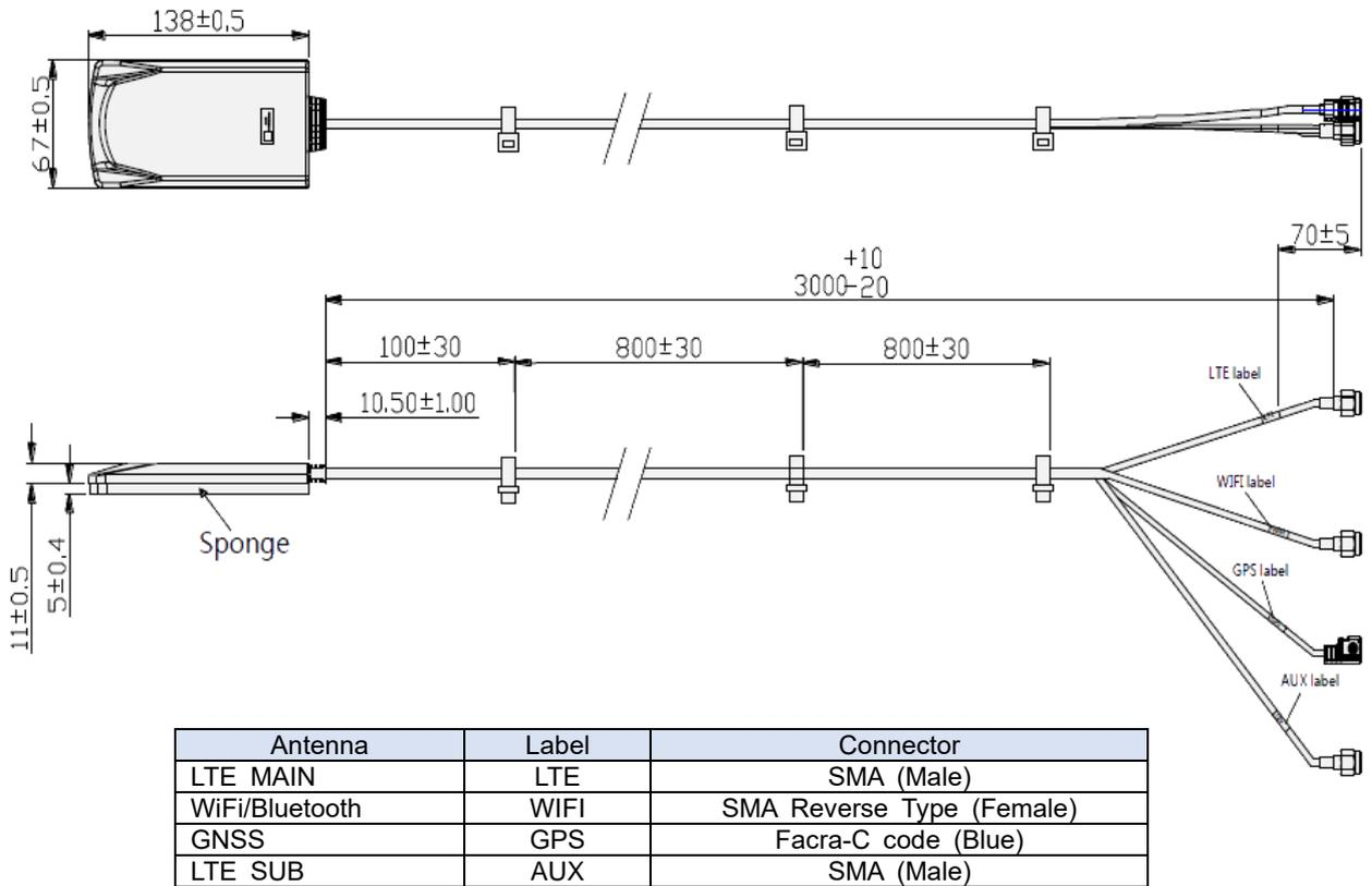
アンテナ部底面には粘着面の有る5mm厚の発泡ゴムが貼り付けられています。特に金属面に取り付ける場合は、アンテナ特性を確保するため、この発泡ゴムをはがさないで下さい。粘着面にマグネットシートを貼り付けて、スチール面へ取り付けることができます。
