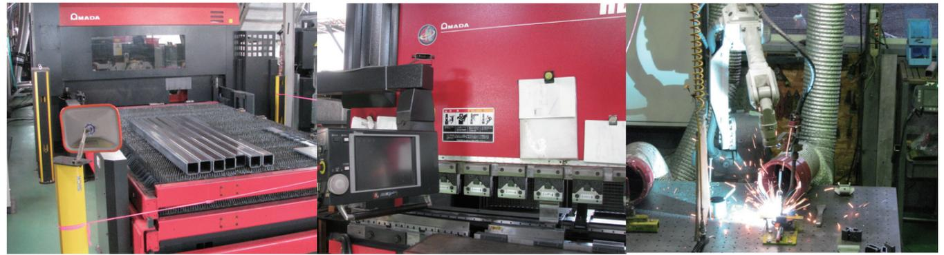
レーザー加工機で、製品の原型を切り取っていきます。角パイプ等の加工も行います。
