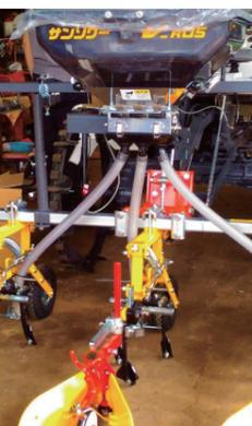
GPS付きは、モード切替で速度連動と従来のダイヤル定量モードの2種類が切替スイッチで出来ます。GPS付きでの除草作業時は速度は最大2km程度での除草作業になります。
