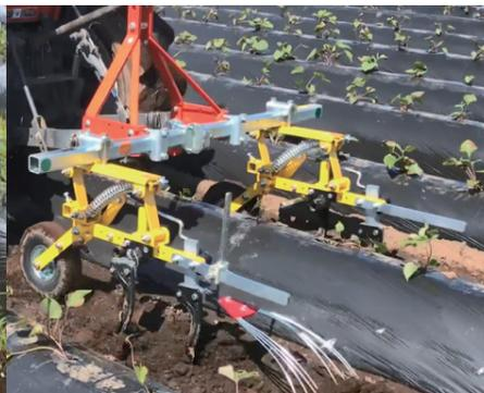
平うねマルチでの中耕の様子。作物は大根のマルチの中耕を乗用形管理機に取付して行なっています。
