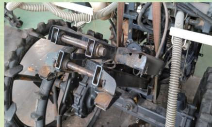
植付部を外します。メーカーによっては植付部を外すと油圧の上下が出来なくなる場合がありますので、確認をしながら作業をしてください。
