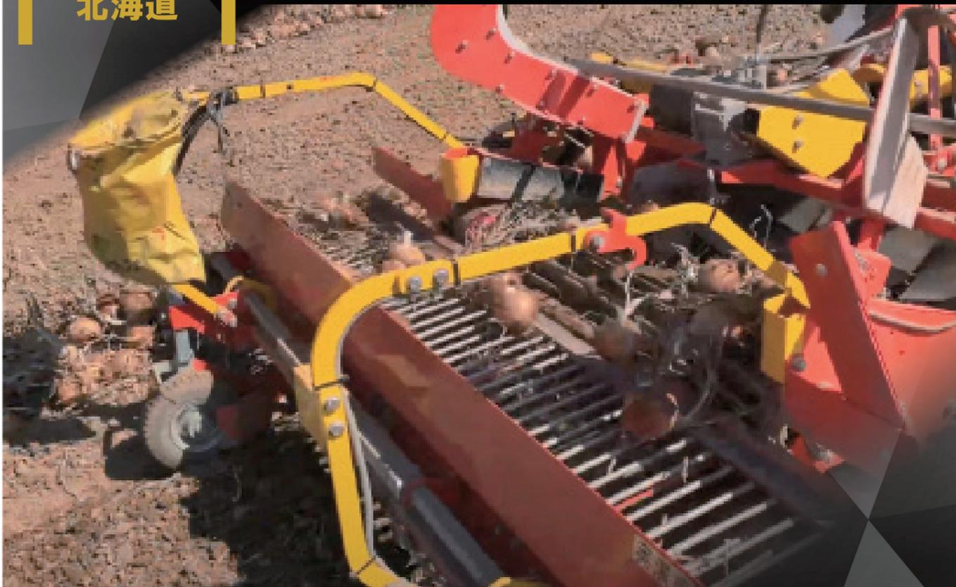
北海道の場合は主に2種類のデガーをおすすめします。第二コンベア部が「ベルトタイプ」と「ロッドタイプ」の2種類が選択出来ます。場所や条件にあわせた玉ねぎデガーが選べます。
