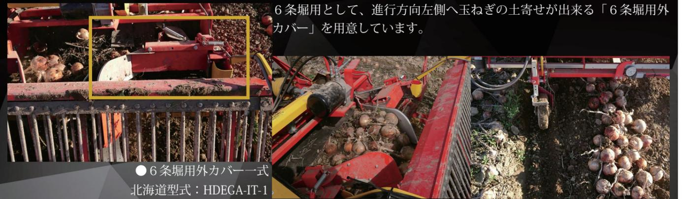
6条堀用として、進行方向左側へ玉ねぎの土寄せが出来る「6条堀用外カバー」を用意しています。
