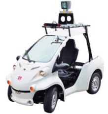
1人乗り超小型電気自動車ベース RoboCar MV2
