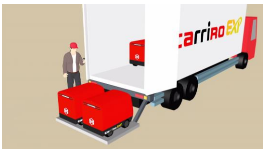
①複数の宅配ロボットをトラックへ積込
